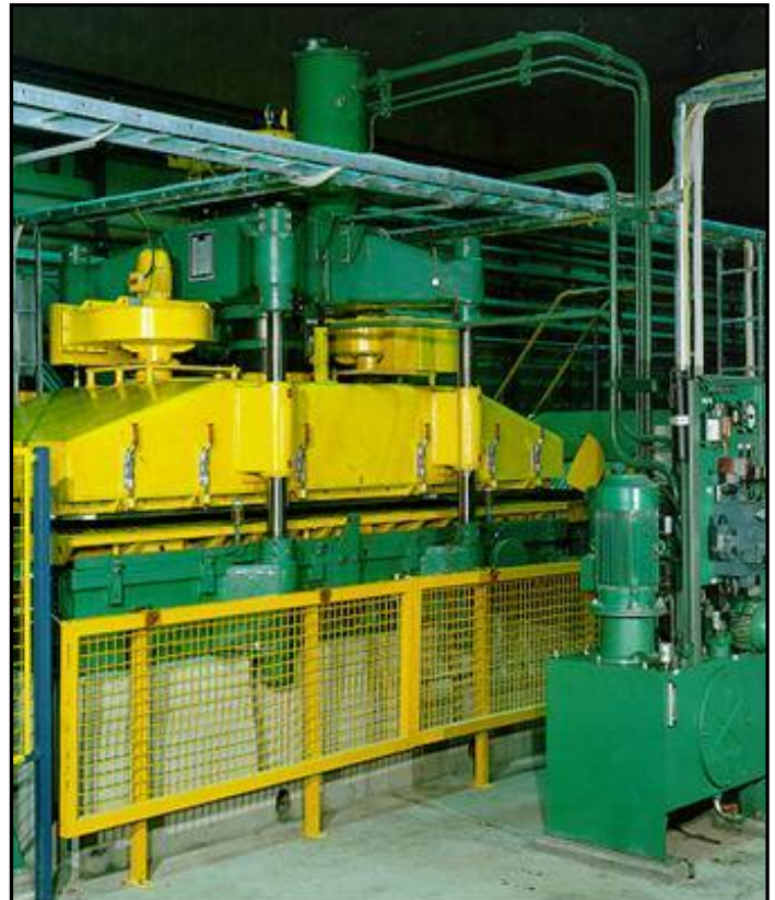
Stanztisch mit eingefahrenem Stanzwagen.
