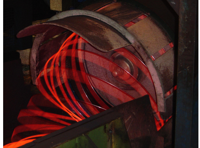
Der ca. 800 °C heisse Stahldraht verlässt den Windungsleger.
